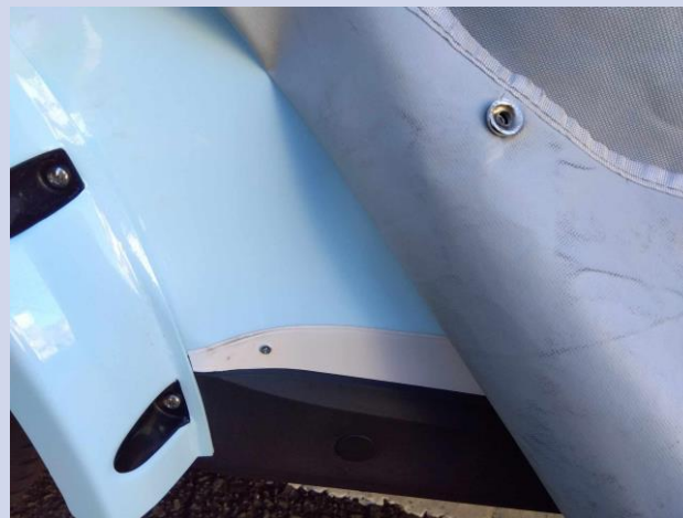
カーテンボタン脱落
